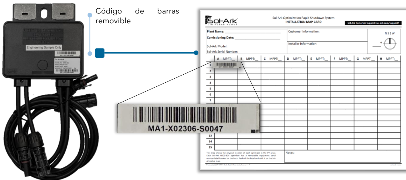
Figura (3.1) Formato para el mapa de instalación utilizado en el proceso de programación del monitoreo.
