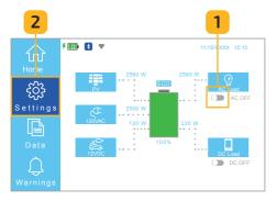
Fig. 6.11 Turn AC output switch OFF
